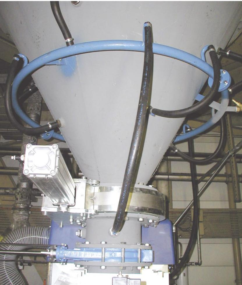
Tripel-Düsen werden zur Austragshilfe für Schüttgüter an Behältern, Silos und Fallrohren eingesetzt. Durch die spezielle Düsenkopf-Formgebung wird ein hoher Auflockerungsgrad erreicht.
