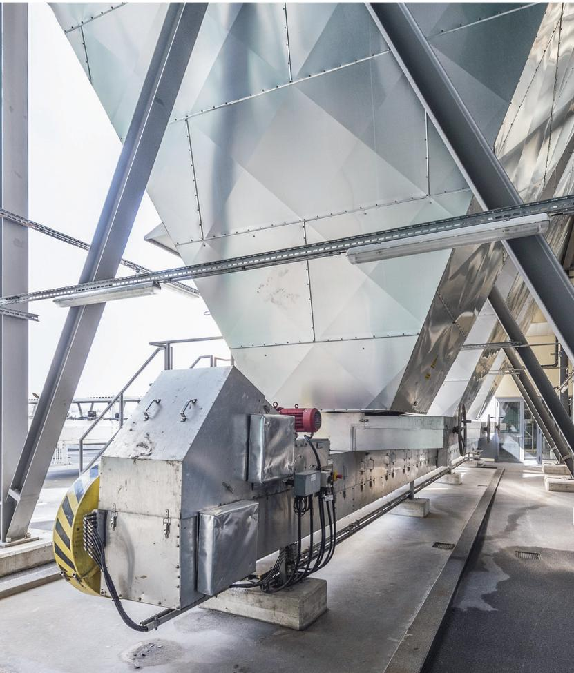
Trogkettenförderer sind Stetigförderer und eignen sich für den Transport von Schüttgütern aller Art bis hin zu kleinstückigen Produkten und Schlamm. Die Vorteile liegen in der hohen Temperaturbeständigkeit (bis 800°C), den kleinen Fördergeschwindigkeiten, speziell bei abrasiven Schüttgütern, der robusten und staubdichten Konstruktion. Die Einsatzmöglichkeiten und Ausführungsvarianten sind sehr vielseitig. Es befinden sich mehr als 260 Geräte mit einer Gesamtlänge von über 3,5 km im Einsatz.
